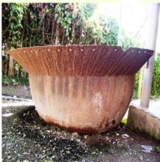
Paila de hierro fundido para la purificación del guarapo y su evaporación, que se utiliza actualmente para almacenar agua en San Miguel de Bagá. Foto de la autora
